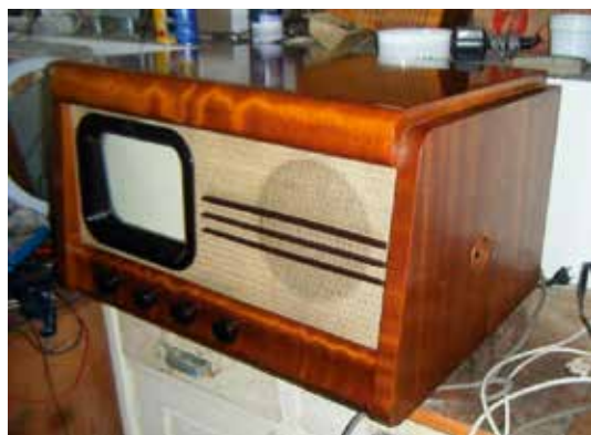
První čs. televizor 4001A, výrobce Tesla Strašnice, výroba 1953–1957. Dřevěná skříň, obrazovka 25QP20 s rozměrem obrazu 150x200 mm, celkem 21 elektronek, napájení 120/220 V, příkon 150 W
